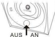
Wenn der Schalter auf An gesetzt wird, leuchtet eine farbige Anzeigelampe im Schalter für einige Sekunden gleichzeitig rot und grün auf, was auf die Initialisierungsphase hinweist.
