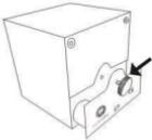
LUXTIME®Qube腕時計ワインダーは、方向ごと900回転/日での初期設置で、連続的に使用される場合、新しい電池の寿命が約3年になります。現在市場における全種類の自動ムーブメント腕時計の基準に満たします。お勧める温度に低い状況において使用する場合、Qube腕時計ワインダーの電池寿命が、明らかに短縮されます。短縮される期間は腕時計の重さによって異なります。電池電力の状態は、LUXTIME®Qube腕時計ワインダーによって、電子制御することができます。もし、スイッチ中の赤表示ランプは、1個または2個のパルス間隔が10秒で連続的に左右点滅する場合、電池の残電力は3ヵ月にも持たなくなりますので、必ず電池を交換しなければなりません。
