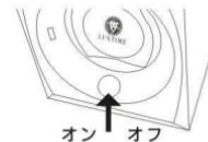
スイッチをオンにセットするときに、スイッチ中のカラー表示ランプが、赤とグリーンが同時に点灯し数秒に続き、装置が初期化していることが表示されます。定義表示ランプについて説明します。
