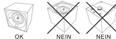
b) Ihre Armbanduhr mit geschlossenem Armband nach dem folgenden Schema auf den Träger aufsetzen.Der Armbanduhrenträger wird aus zwei flexiblen Systemen gebildet(eine Feder und ein Sitz aus weichem Gummi),mit denen sie an die verschiedenen Armbandlängen angepasst werden können.
