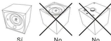
b) Coloque el reloj bien apretado con la correa en el portarelojes según el dibujo abajo. El portarelojes, formado por dos sistemas flexibles(un resorte y una base hecha por goma blanda), puede ajustarse a correas de diferente longitud.
